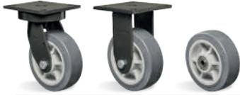
**RODA BP - Composto Termoplástico com PVC. Dureza: 85 Shore A. (-10°C a +50°C).** Produzida com revestimento em composto termoplástico com PVC e núcleo em polipropileno copolímero recicláveis. Proporciona rotação macia e silenciosa, ótima proteção ao piso, excelente resistência química, boa resistência ao desgaste e aos impactos, resultando em ótima relação custo/benefício. A velocidade de trabalho indicada é até 4km/h.
