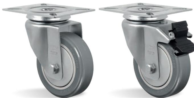
**RODA BP - Composto Termoplástico com PVC. Dureza: 85 Shore A. (-10°C a +50°C).** Produzida com revestimento em composto termoplástico com PVC e núcleo em polipropileno copolímero recicláveis. Proporciona rolagem macia e silenciosa, ótima proteção ao piso, excelente resistência química, boa resistência ao desgaste e aos impactos, resultando em ótima relação custo/benefício. A velocidade de trabalho indicada é até 4km/h.
