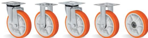
**RODA UP - Poliuretano Termoplástico. Dureza: 90 Shore A. (-20°C a +70°C).** Produzida com revestimento em poliuretano termoplástico elastollan e núcleo em polipropileno copolímero recicláveis. Ideal para quem procura excelente capacidade de carga aliada a uma ótima proteção do piso com baixo ruído no deslocamento, proporciona excelente resistência a abrasão e impactos. Resistente a graxas, óleos minerais e alguns ácidos. A velocidade de trabalho indicada é até 4 km/h.
