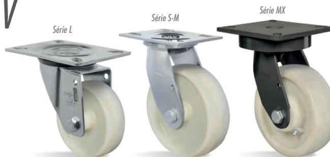
**RODA NFV - Nylon Reforçado com Fibra de Vidro. Dureza: 80 Shore D. (-40°C a +180°C).** Produzidas com Poliamida 6.6 (Nylon) reforçado com fibra de vidro. Indicadas para aplicações em altas e baixas temperaturas. São leves, possuem ótima resistência mecânica, rodam com muita facilidade exigindo menor esforço para manobras e movimentação. São resistentes a graxas, óleos, sais e alguns tipos de ácidos. A velocidade de trabalho indicada é até 4km/h.
