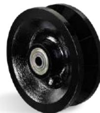
V - Grooved - Ferro com Canal em V. Dureza: 160 Brinell. (-40°C a +400°C). Produzidas com ferro fundido cinzento, possuem canal em “V” na banda de rodagem. Projetadas para montagem sobre cantoneiras, rodam com facilidade e proporcionam grande redução do esforço de movimentação. São muito resistentes e suportam cargas e temperaturas elevadas.
