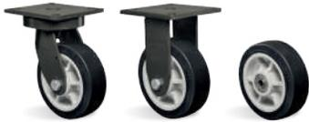
**RODA TP - Composto Termoplástico. Dureza: 85 Shore A. (-10°C a +50°C).** Produzida com revestimento em composto termoplástico e núcleo em polipropileno copolímero recicláveis. Proporciona rodamem macia e silenciosa, ótima proteção ao piso, excelente resistência química, boa resistência ao desgaste e impactos, resultando em ótima relação custo/benefício. A velocidade de trabalho indicada é até 4km/h.
