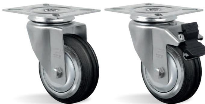
**RODA BD - Borracha Maciça com Núcleo em Chapa Estampada. Dureza: 80 Shore A. (-20°C a +70°C).** Produzida com aro de borracha maciça, com núcleo em chapas de aço carbono estampado, com acabamento zincado. É leve e resistente, tem rolagem macia e silenciosa, e é indicada para serviços leves em pisos em bom estado. A velocidade de trabalho indicada é até 4 km/h.
