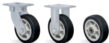
**RODATP - Composto Termoplástico. Dureza: 85 Shore A. (-10°C a +50°C).** Produzida com revestimento em composto termoplástico e núcleo em polipropileno copolímero recicláveis. Proporciona rodagem macia e silenciosa, ótima proteção ao piso, excelente resistência química, boa resistência ao desgaste e impactos, resultando em ótima relação custo/benefício. A velocidade de trabalho indicada é até 4km/h.
