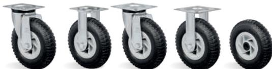
**RODA RIT PP - Pneumática - Núcleo de Nylon (-20°C a +50°C) - Calibragem: 30 lb/pol<sup>2</sup>.** Fabricada com pneu e câmara de ar e núcleo injetado em nylon. Indicada para aplicações em pisos irregulares onde é necessário facilidade de movimentação e amortecimento dos impactos e vibrações. Proporciona fácil manutenção, e seus componentes podem ser fornecidos separadamente. A velocidade de trabalho indicada é até 4km/h.
