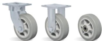
**RODA SP - Borracha Termoplástica Extra Macia. Dureza: 65 Shore A. (-10°C a +50°C).** Roda injetada com revestimento em borracha termoplástica extra macia e núcleo em polipropileno copolímero recicláveis. Suas vantagens são o baixíssimo nível de ruído no deslocamento e a redução de vibrações. Indicada para movimentações de cargas leves, proporciona excelente proteção ao piso, resistência regular a impactos e boa resistência a meios químicos. A velocidade de trabalho indicada é até 4km/h.
