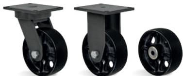
**RODA F - Ferro Fundido. Dureza: 160 Brinell. (-40°C a +400°C).** Produzida com ferro fundido cinzento, roda com muita facilidade e proporciona grande redução do esforço de movimentação. É muito resistente e suporta cargas e temperaturas elevadas. Não é indicada para a utilização quando o nível de ruídos e a conservação do piso são necessários. A velocidade de trabalho indicada é até 4 km/h.
