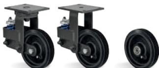
**RODA B - Borracha Moldada. Dureza: 80 Shore A. (-20°C a +70°C).** Produzida com revestimento de borracha moldada vulcanizada em núcleo de ferro fundido cinzento. Roda com suavidade e baixo nível de ruídos, absorve choques e vibrações. É resistente à abrasão e produtos químicos. Fornecida com graxeira para lubrificação quando montada com rolamento de roletas ou sob solicitação. Pode ser utilizada em velocidades de até 20km/h quando montada com rolamentos de esferas.
