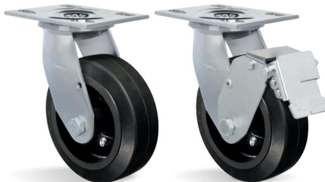
**RODA B - Borracha Moldada. Dureza: 80 Shore A. (-20°C a +70°C).** Produzida com revestimento de borracha moldada vulcanizada em núcleo de ferro fundido cinzento. Roda com suavidade e baixo nível de ruídos, absorve choques e vibrações. É resistente à abrasão e produtos químicos. Fornecida com graxeira para lubrificação quando montada com rolamento de roletes ou sob solicitação. Pode ser utilizada em velocidades de até 4km/h.
