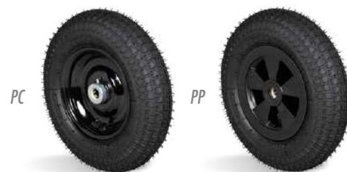
Fabricadas com pneu e câmara de ar, com núcleo em chapas de aço carbono estampado e acabamento pintado ou núcleo de polipropileno injetado. Indicadas para aplicações em pisos irregulares onde é necessário facilidade de movimentação e amortecimento dos impactos e vibrações. Proporcionam fácil manutenção e seus componentes podem ser fornecidos separadamente. A velocidade de trabalho indicada é até 4km/h.
