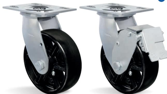
**RODA F - Ferro Fundido. Dureza: 160 Brinell. (-40°C a +400°C).** Produzida com ferro fundido cinzento, roda com muita facilidade e proporciona grande redução do esforço de movimentação. É muito resistente e suporta cargas e temperaturas elevadas. Não é indicada para a utilização quando o nível de ruídos e a conservação do piso são necessários. A velocidade de trabalho indicada é até 4 km/h.
