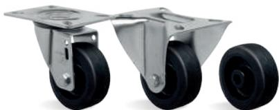
**RODA B - Borracha Moldada. Dureza: 80 Shore A. (-20°C a +70°C).** Produzida com revestimento de borracha moldada vulcanizada em núcleo de ferro fundido cinzento. Roda com suavidade e baixo nível de ruídos, absorve choques e vibrações. É resistente à abrasão e produtos químicos. Pode ser utilizada em velocidades de até 4km/h.
