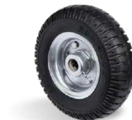
PM - Borracha Maciça com Núcleo de Chapa Estampada. Dureza: 80 Shore A. (-20°C a +70°C). Produzidas com aro de borracha maciço, com núcleo em chapa estampada com acabamento zincado. São leves e resistentes, tem rodagem macia e silenciosa, e são indicadas para serviços leves em pisos em bom estado. A velocidade de trabalho indicada é até 4km/h.
