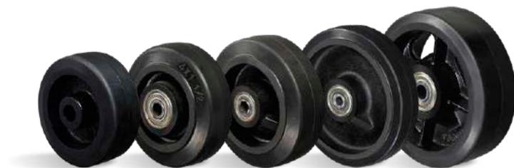
**B - Borracha Moldada. Dureza: 80 Shore A. (-20°C a +70°C).** Produzidas com revestimento de borracha moldada vulcanizada em núcleo de ferro fundido cinzento. Rodam com suavidade e baixo nível de ruídos, absorvem choques e vibrações. São resistentes a abrasão e produtos químicos. A velocidade de trabalho indicada é de até 20km/h, quando montadas com rolamentos de esferas e garfos apropriados.
