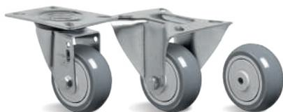
**RODA BP - Composto Termoplástico com PVC. Dureza: 85 Shore A. (-10°C a +50°C).** Produzida com revestimento em composto termoplástico com PVC e núcleo em polipropileno copolímero recicláveis. Proporciona rodagem macia e silenciosa, ótima proteção ao piso, excelente resistência química, boa resistência ao desgaste e aos impactos, resultando em ótima relação custo/benefício. A velocidade de trabalho indicada é até 4km/h.
