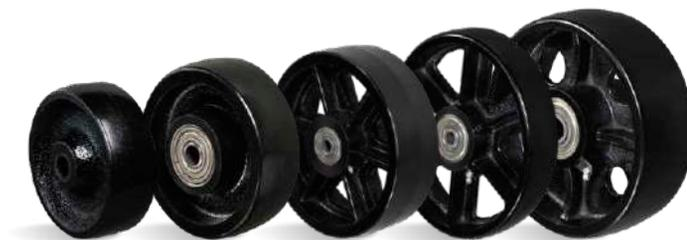
F - Ferro Fundido. Dureza: 160 Brinell. (-40°C a +400°C). Produzidas com ferro fundido cinzento, rodam com muita facilidade e proporcionam grande redução do esforço de movimentação. São muito resistentes e suportam cargas e temperaturas elevadas. Não são indicadas para a utilização quando o nível de ruídos e a conservação do piso são necessários. A velocidade de trabalho indicada é até 4 km/h.
