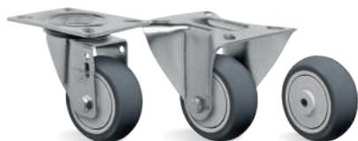
**RODATB - Borracha Termoplástica. Dureza: 80 Shore A. (-20°C a +70°C).** Produzida com revestimento em borracha termoplástica e núcleo em polipropileno copolímero recicláveis. Apresenta excelente proteção ao piso, rodagem macia e silenciosa, facilidade para movimentação e manobras, resiste a impactos, possui baixa deformação sob carga e excelente resistência a abrasão. Possui boa resistência a intempéries e a agentes químicos como sais e graxas. A velocidade de trabalho indicada é até 4km/h.
