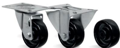
**RODA F - Ferro Fundido. Dureza: 160 Brinell. (-40°C a +400°C).** Para cada faixa de temperatura, existe um tipo de mancal adequado. Consulte-nos. Produzida com ferro fundido cinzento, roda com muita facilidade e proporciona grande redução do esforço de movimentação. É muito resistente e suporta cargas e temperaturas elevadas. Não é indicada para a utilização quando o nível de ruídos e a conservação do piso são necessários. A velocidade de trabalho indicada é até 4 km/h.
