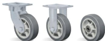
**RODA BP - Composto Termoplástico com PVC. Dureza: 85 Shore A. (-10°C a +50°C).** Produzida com revestimento em composto termoplástico com PVC e núcleo em polipropileno copolímero recicláveis. Proporciona rodagem macia e silenciosa, ótima proteção ao piso, excelente resistência química, boa resistência ao desgaste e aos impactos, resultando em ótima relação custo/benefício. A velocidade de trabalho indicada é até 4km/h.
