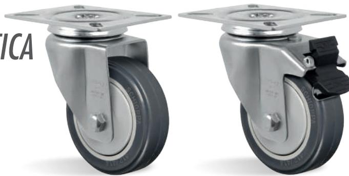
**RODA TB - Borracha Termoplástica. Dureza: 80 Shore A. (-20°C a +70°C).** Produzida com revestimento em borracha termoplástica e núcleo em polipropileno copolímero recicláveis. Apresenta excelente proteção ao piso, rodagem macia e silenciosa, facilidade para movimentação e manobras, resiste a impactos, possui baixa deformação sob carga e excelente resistência a abrasão. Possui boa resistência a intempéries e a agentes químicos como sais e graxas. A velocidade de trabalho indicada é até 4km/h.
