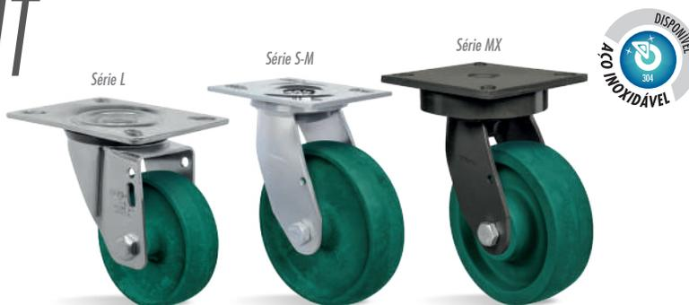
**RODA NHT - Composto Termoplástico Reforçado com Fibra de Vidro. Dureza: 85 Shore D. (-20°C a +220°C).** Produzidas com composto termoplástico de engenharia, reforçado com fibra de vidro. Indicadas para aplicações em altas e baixas temperaturas. São leves, possuem ótima resistência mecânica, rodam com muita facilidade exigindo menor esforço para manobras e movimentação. São resistentes a graxas, óleos, sais e alguns tipos de ácidos. A velocidade de trabalho indicada é até 4km/h.
