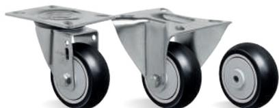
**RODA NP - Polipropileno. Dureza: 65 Shore D. (-20°C a +70°C).** Injetada com revestimento e núcleo em polipropileno copolímero reciclável. Indicada para cargas leves e médias, roda com muita facilidade requerendo pouco esforço para movimentação, não deforma sob carga estática e possui ótima relação custo/benefício. Apresenta boa resistência química e a impactos moderados. A velocidade de trabalho indicada é até 4 km/h.
