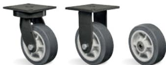
**RODA TB - Borracha Termoplástica. Dureza: 80 Shore A. (-20°C a +70°C).** Produzida com revestimento em borracha termoplástica e núcleo em polipropileno copolímero recicláveis. Apresenta excelente proteção ao piso, rolagem macia e silenciosa, facilidade para movimentação e manobras, resiste a impactos, possui baixa deformação sob carga e excelente resistência à abrasão. Possui boa resistência a intempéries e a agentes químicos como sais e graxas. A velocidade de trabalho indicada é até 4km/h.
