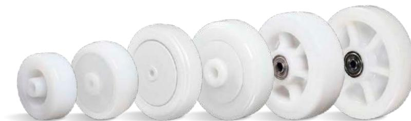
NT - Nylon Técnico. Dureza: 75 Shore D. (-40°C a +110°C). Produzidas com revestimento e núcleo em Poliamida 6 (Nylon) de alta qualidade. São leves e possuem ótima resistência mecânica, rodam com muita facilidade exigindo menor esforço para manobras e movimentação. Ideais para aplicações em ambientes úmidos, são resistente as graxas, óleos, sais e alguns tipos de ácidos. Fabricadas com material reciclável. A velocidade de trabalho indicada é até 4km/h.
