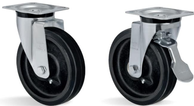
**RODA B - Borracha Moldada. Dureza: 80 Shore A. (-20°C a +70°C).** Produzida com revestimento de borracha moldada vulcanizada em núcleo de ferro fundido cinzento. Roda com suavidade e baixo nível de ruído, absorve choques e vibrações. Fornecida com graxeira para lubrificação quando montada com rolamento de roletes ou sob solicitação. É resistente à abrasão e produtos químicos. Pode ser utilizada em velocidades de até 4km/h.
