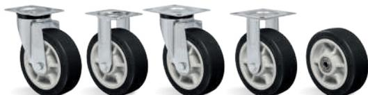
**RODA TP - Composto Termoplástico.** Dureza: 85 Shore A. (-10°C a +50°C). Produzida com revestimento em composto termoplástico e núcleo em polipropileno copolímero recicláveis. Proporciona rodagem macia e silenciosa, ótima proteção ao piso, excelente resistência química, boa resistência ao desgaste e impactos, resultando em ótima relação custo/benefício. A velocidade de trabalho indicada é até 4km/h.
