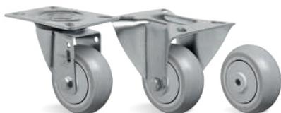
**RODA SP - Borracha Termoplástica Extra Macia. Dureza: 65 Shore A. (-10°C a +50°C).** Roda injetada com revestimento em borracha termoplástica extra macia e núcleo em polipropileno copolímero recicláveis. Suas vantagens são o baixíssimo nível de ruído no deslocamento e a redução de vibrações. Indicadas para movimentações de cargas leves, proporcionam excelente proteção ao piso, resistência regular a impactos e boa resistência a meios químicos. A velocidade de trabalho indicada é até 4km/h.
