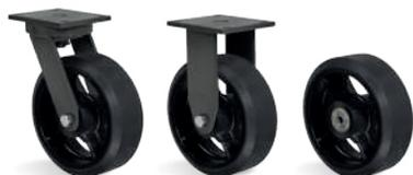
**RODA B - Borracha Moldada. Dureza: 80 Shore A. (-20°C a +70°C).** Produzida com revestimento de borracha moldada vulcanizada em núcleo de ferro fundido cinzento. Roda com suavidade e baixo nível de ruídos, absorve choques e vibrações. É resistente à abrasão e produtos químicos. Pode ser utilizada em velocidades de até 20km/h.
