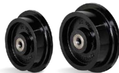
DV - Decauville - Ferro para Trilho. Dureza: 160 Brinell. (-40°C a +400°C). Produzidas com ferro fundido cinzento, possui uma aba na lateral da banda de rodagem. Projetadas para montagens sobre trilhos ou vigas. Rodam com muita facilidade e proporcionam grande redução do esforço de movimentação. São muito resistentes e suportam cargas e temperaturas elevadas.
