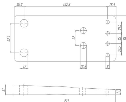
Placa de Elastômero Termoplástico de ótima resistência mecânica. Utilizada em equipamentos para depilar suínos em indústria do ramo alimentício.
