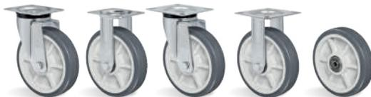
**RODA TB - Borracha Termoplástica.** Dureza: 80 Shore A. (-20°C a +70°C). Produzida com revestimento em borracha termoplástica e núcleo em polipropileno copolímero recicláveis. Apresenta excelente proteção ao piso, rodamem macia e silenciosa, facilidade para movimentação e manobras, resiste a impactos, possui baixa deformação sob carga e excelente resistência a abrasão. Possui boa resistência a intempéries e a agentes químicos como sais e graxas. A velocidade de trabalho indicada é até 4km/h.
