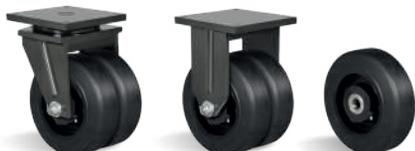
**RODA BS - Borracha Moldada com Camada Dupla. Dureza: 80 Shore A. (-20°C a +70°C).** Produzida com revestimento de borracha moldada com camada dupla vulcanizada em núcleo de ferro fundido cinzento. Ideal para aplicações em pisos externos, proporciona grande absorção de choques e vibrações, alta resistência à abrasão, e maior vida útil devido sua camada de borracha de maior espessura. Resiste a produtos químicos. Pode ser utilizada a uma velocidade de até 20km/h.
