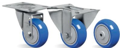
**RODA TP - Composto Termoplástico. Dureza: 85 Shore A. (-10°C a +50°C).** Produzida com revestimento em composto termoplástico e núcleo em polipropileno copolímero recicláveis. Proporciona rodagem macia e silenciosa, ótima proteção ao piso, excelente resistência química, boa resistência ao desgaste e impactos, resultando em ótima relação custo/benefício. A velocidade de trabalho indicada é até 4km/h.
