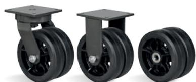
**RODA B - Borracha Moldada. Dureza: 80 Shore A. (-20°C a +70°C).** Produzida com revestimento de borracha moldada vulcanizada em núcleo de ferro fundido cinzento. Roda com suavidade e baixo nível de ruídos, absorve choques e vibrações. É resistente à abrasão e produtos químicos. Pode ser utilizada em velocidades de até 20km/h quando montada com rolamento de esferas.
