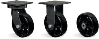
**RODA F - Ferro Fundido. Dureza: 160 Brinell. (-40°C a +400°C).** Produzida com ferro fundido cinzento, roda com muita facilidade e proporciona grande redução do esforço de movimentação. É muito resistente e suporta cargas e temperaturas elevadas. Não é indicada para a utilização quando o nível de ruídos e a conservação do piso são necessários. A velocidade de trabalho indicada é até 4 km/h.
