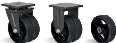
**RODA B - Borracha Moldada. Dureza: 80 Shore A. (-20°C a +70°C).** Produzida com revestimento de borracha moldada vulcanizada em núcleo de ferro fundido cinzento. Roda com suavidade e baixo nível de ruídos, absorve choques e vibrações. É resistente à abrasão e produtos químicos. Pode ser utilizada em velocidades de até 20km/h quando montada com rolamento de esferas.
