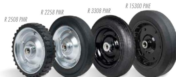
PM - Borracha Maciça. Dureza: 80 Shore A. (-20°C a +70°C). Produzidas com aro de borracha maciça na cor preta e flanges (núcleo) em chapas de aço carbono estampadas. Não necessitam de manutenção e não furam. Indicadas para uso em piso irregular, transpõem obstáculos com facilidade. As flanges são presas por parafusos que facilitam a montagem e reposição dos seus componentes, que podem ser fornecidos separadamente. A velocidade de trabalho indicada é até 4km/h.
