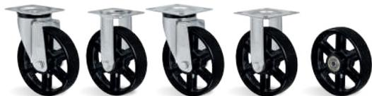
**RODA F - Ferro Fundido. Dureza: 160 Brinell. (-40°C a +400°C).** Para cada faixa de temperatura, existe um tipo de mancal adequado. Consulte-nos. Produzida com ferro fundido cinzento, roda com muita facilidade e proporciona grande redução do esforço de movimentação. É muito resistente e suporta cargas e temperaturas elevadas. Não é indicada para a utilização quando o nível de ruídos e a conservação do piso são necessários. A velocidade de trabalho indicada é até 4 km/h.
