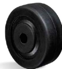
**BIN - Borracha Moldada - Núcleo de Ebonite. Dureza 80 Shore A. (-20°C a +70°C).** Produzidas com revestimento de borracha moldada vulcanizada em núcleo de ebonite. São leves, rodam com suavidade e baixo nível de ruído, absorvem choques e vibrações e não oxidam. São resistentes a abrasão e a produtos químicos. A velocidade de trabalho indicada é de até 4km/h.
